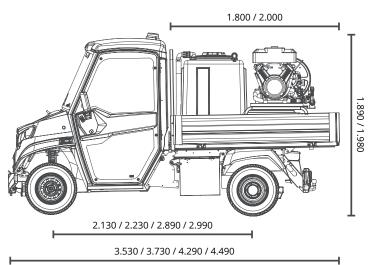
Este módulo de combate a incêndios pode ser instalado nos modelos ATX 330E/ED/EH/EDH e ATX 340E/ED/EH/EDH da ALKE' e consiste num depósito de 600 litros, equipado com um enrolador de mangueira de 50 m e pistola de incêndio. O extintor de água é adequado para fogos de material sólido e o seletor na pistola permite escolher entre jato completo ou
